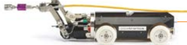
PI.TRON Zestaw Hydrojet DN 200-800; Profile kanału kołowe/jajowe
